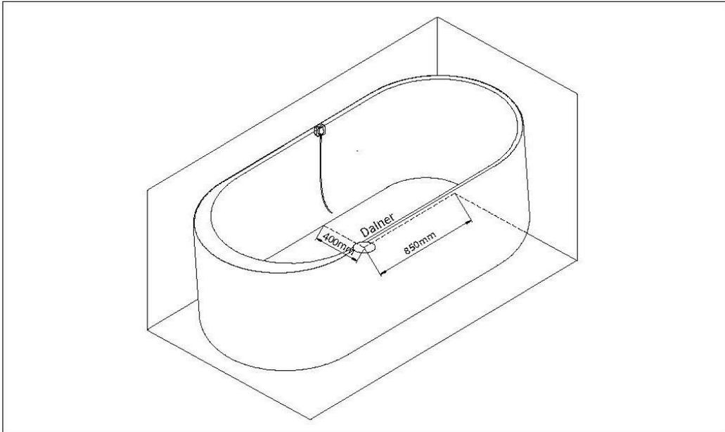
3. Drehen Sie die Badewanne auf den Kopf. Verbinden Sie das Ablaufventil mit dem Ablauf. Wir empfehlen, den Abfluss mit etwas Dichtungsband oder Silikon abzudichten, um späteren Wasseraustritt zu vermeiden.
