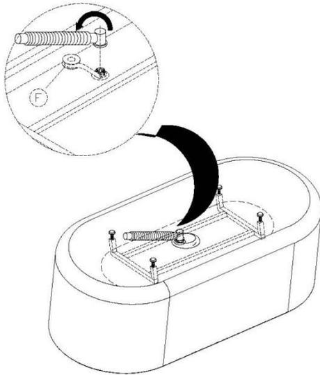
4. Montieren Sie nun die vier FüÙe und richten Sie diese mithilfe einer Wasserwaage gerade aus. Achten Sie beim Aufstellen der Badewanne darauf, dass alle FüÙe auf dem Boden stehen.
